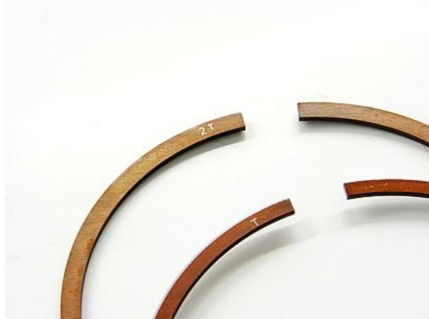
In die unterste Nut gehört der kupferfarbene Kolbenring (2T) und in die obere der zweifarbige Kolbenring (T). Auch zu unterscheiden an der Fläche, die schließlich an der Zylinderwandung läuft. Die des unteren Kolbenringes ist kupfern und die des oberen silbern, poliert und chromfarben.
