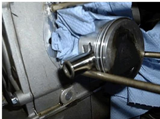
Jetzt müsst Ihr alle Dichtflächen am Zylinderfuß und dem Zylinderkopf von den alten Dichtungsresten entfernen und säubern, denn sonst kann es sehr leicht passieren, dass die neuen Dichtungen undicht werden. Dann habt ihr das Problem, euren Motor nochmals zu zerlegen und das will ja auch keiner.
